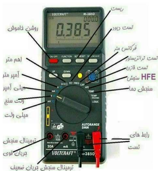
شکل ۱۷- معرفی قسمت های مختلف یک مدل مولتی متر دیجیتالی
