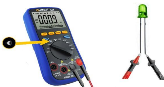
شکل ۲۸ - تست صحت ال ای دی با مولتی متر
